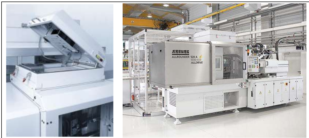
1. ábra Egy Allrounder típusú fröccsöntő gép szerszámfelfogó lapjai fölé épített tisztatéri modul ionizátort és szűrőket tartalmazó felső része (bal oldali kép) és a teljes modul elhelyezkedése a fröccsgépen, mögötte a kiegészítő műveleteket elvégzésére szolgáló, ugyancsak tisztatéri kamra (jobb oldali kép)
