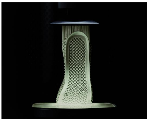
1. ábra Az Adidas cég Futurecraft 4D futócipőjének betétrétege eltérően alakuló hálós szerkezeteket tartalmaz
