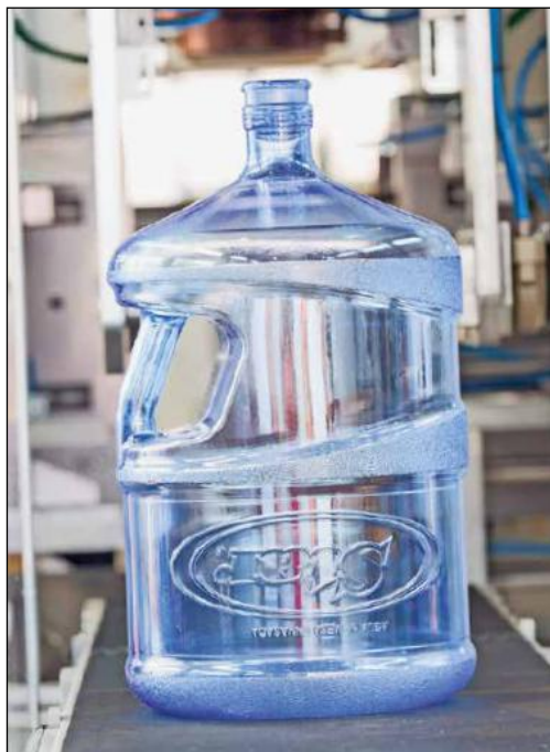
1. ábra A Bekum berendezésén fűjt fogantyús palack a futószalagon
