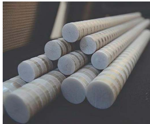
3. ábra. FRP rudakkal erősített beton. Kompozit beton, az acélszállal erősített beton alternatívája.
