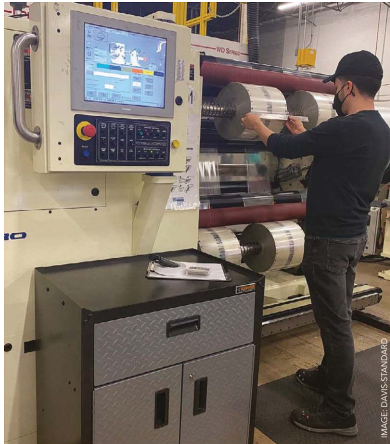
1. ábra. A Dearco cég egyik felvágó-csévélő gépe.
