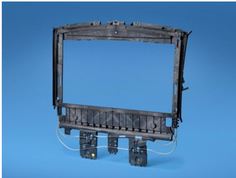
2. ábra Az Asahi Kasei Thermylene habosítható polipropilénjéből készült napfénytető modul
