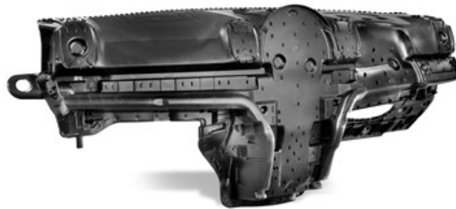
1. ábra A SABIC díjnyertes műszerfal hordozója hosszú üvegszálal Stamax PP-ből készült, a habosítás 15%-kal csökkentette a súlyt
