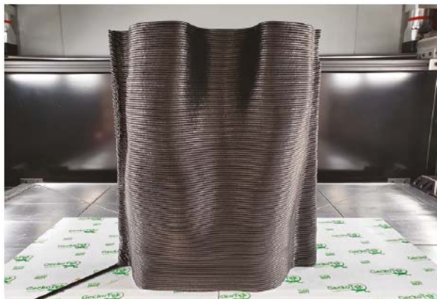
2. ábra FGF technológiával, a Tradesman Series P3-44 berendezéssel EcoPaXX PA411 márkájú DSM poliamidból nyomtatott termék
