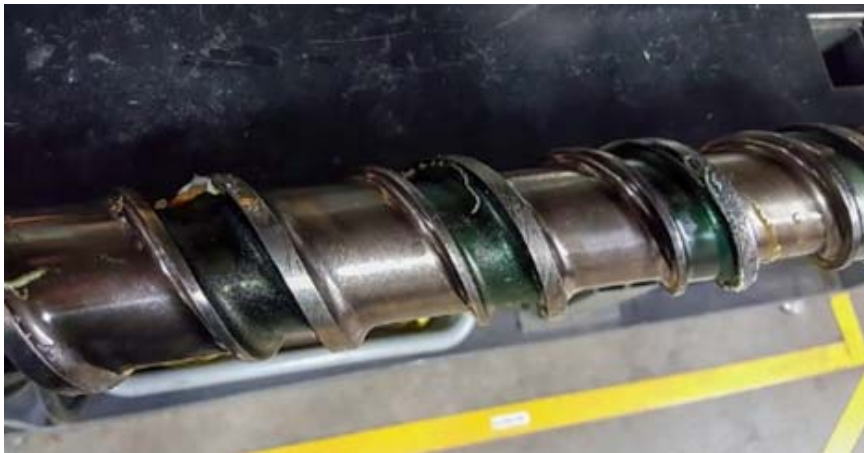
3. ábra A barrier csigán tisztítás után visszamaradt zöld polimer a későbbiekben degradálódni fog és rontja a termék minőségét
