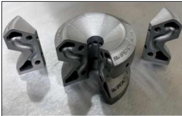
1. ábra 3D nyomtatással lehetséges a hűtőcsatornákat az alakadó felületek közelében vezetve (ld. kivágott részt) csökkenteni a ciklusidőt és az egyenletesebb hűtéssel javítani a minőséget
