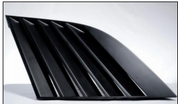
2. ábra Az EcoJet gépkocsi 3D nyomtatással készült oldalszellőzője festés és lakkozás után kiváló felületi minőségű
