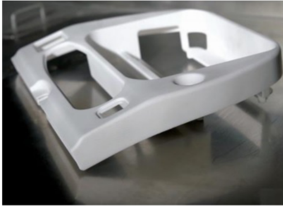
3. ábra Az Emirates Airlines repülőgépein használatos 3D nyomtatású videoképernyő burkolatok lehetővé teszik a pótalkatrészek raktározása nélküli gyors pótlást (digitális raktár)
