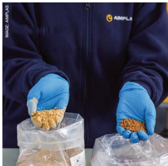
10. ábra. Az Aimplas olívamagvakból származó töltőanyagok felhasználását vizsgálja az Oliplast projektben.
