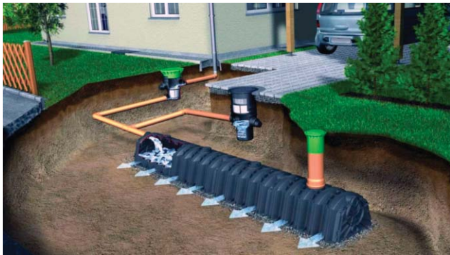
3. ábra. Egy családi ház kertjében a földbe fektetett szennyvíz-tartályból csak szűrés után szivároghat be a földbe a víz.
