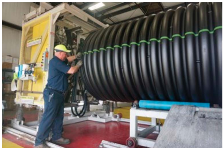
2. ábra. Az ADS N12 jelű hullámos felületű dupla falú PE-HD csöve. Ezt esővíz kezelésére és mezőgazdasági öntözőrendszer kiépítéséhez ajánlják.
