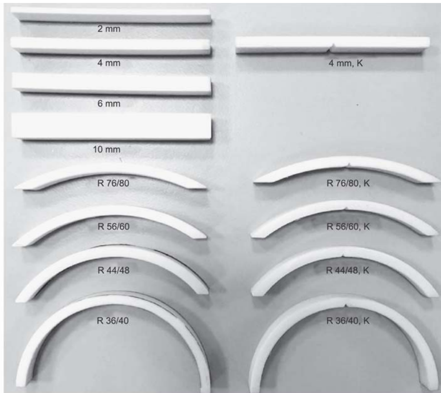
1. ábra. Az ütévizsgálathoz használt különböző vastagságú és görbületű minták. A görbe minták vastagsága egységesen 4 mm, ezek esetében az első szám a belső, a második szám a külső sugár nagyságát jelöli. A „K” jelölésű minták a DIN EN ISO 179-1 szabvány szerint V-alakú, A-típusú hornyolással készültek.
