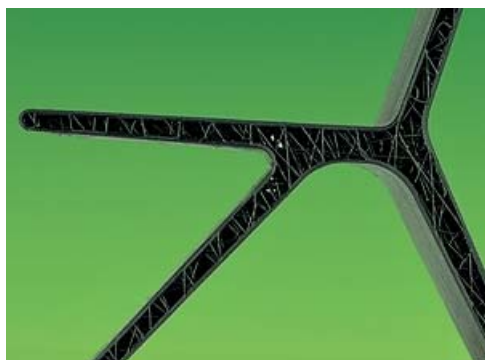
1. ábra Üvegszál erősítésű, reciklált PET-ből 3D nyomtatással előállított szék
