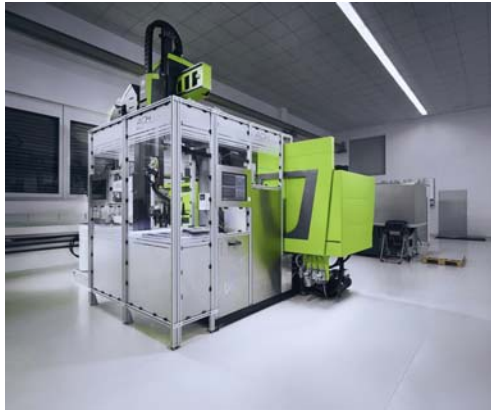
3. ábra Az Engel és az ACH Solution együttműködésével előállított „kulcsrakész” gyártóberendezés, ahol a fröccsgép össze van építve a tisztatéri egységgel
