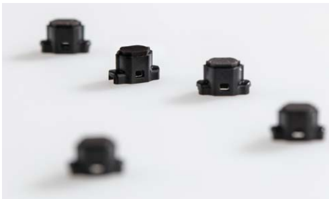
4. ábra Gépkocsiülések masszázsfunkciójának megteremtésére gyártott levegőfúvókák. Méretük 4x3 mm, belső részük poliamidból készült, külső burkolatukat LSR-rel ráfröccsöntéssek készítették.
