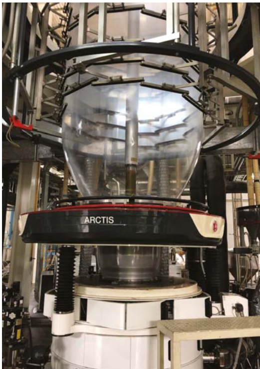
1. ábra A W&H cég Arctis XP hűtőgyűrűje a PTPlasindo Lestari ötrétegű fólia fűvő extruder gyártósorán
