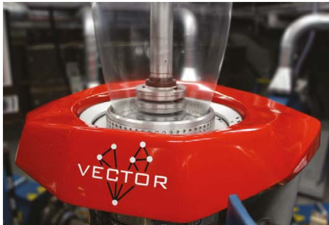
2. ábra A Davis-Standard Vector elnevezésű egy légbemenetű hűtőgyűrűje, szabadalmaztatott kétajkú kialakítással
