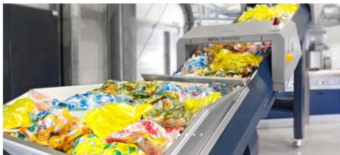
2. ábra Az Intarema TVEplus extruder automatikus betáplálása hulladékkal
