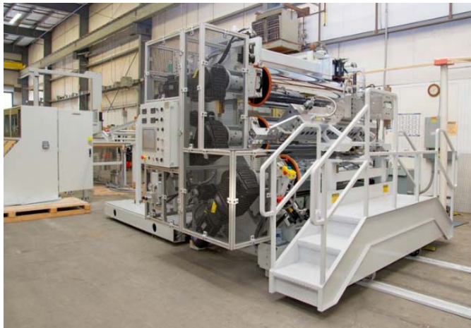
2. ábra J-alakú hengersor elrendezés. Javasolt rPET, PETG, GP-PS, PP polimerekhez
