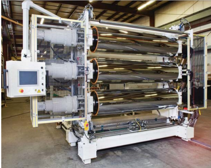
1. ábra Függőleges hengersor elrendezés. Jól használható a PMMA lemez extrudálásban
