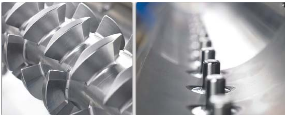
3. ábra A ko-knéter 2-4 bevágást tartalmazó csigaszárnnyai (balra) és a henger belső falába beépített stabil ütközőelemek (jobbra)
