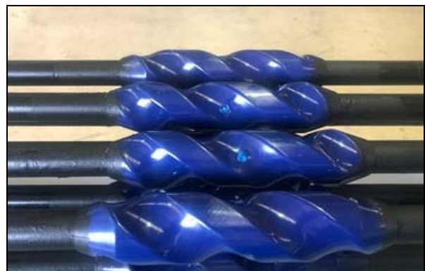
2. ábra Olajkutak szivattyúinál használt összekötő rudak kiképzése
