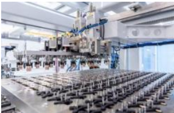
9. ábra A Hekuma kiegészítő funkciókat tartalmazó megfogó szerkezete
