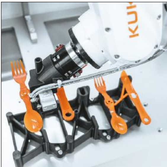
1. ábra A Kuka KR Agilus kisrobotja elrendezi a fröccsöntött evőeszközöket
