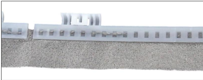
3. ábra Az új eljárással előállított textillel erősített szalag
