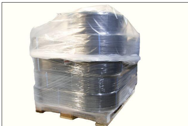
2. ábra A streccsfóliával körültekert rakomány stabilitását zsugorfóliával erősíthetik
