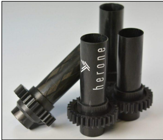
3. ábra Hajtótengely fonatolt UD szalagból, ráfröccsöntött fogaskerékkel
