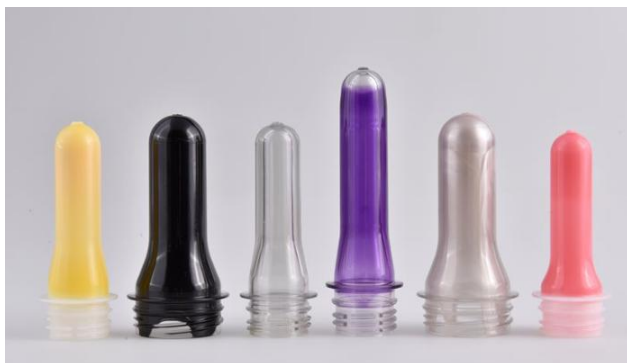
5. ábra Kofröccsöntéssel gyártott három-rétegű PET palack előformák, amelyek középső rétege a CO 2 áthatolását gátolja
