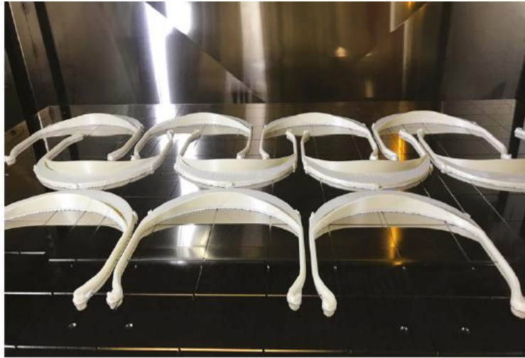
1. ábra A Stratasys 3D nyomtatójával gyártott koronavírus elleni arcvédő pajzsok keretei
