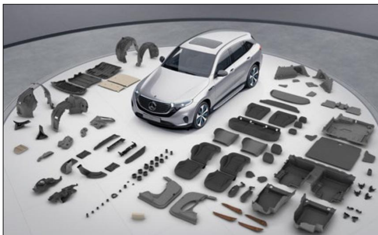
1. ábra Erőforrás-kímélő anyagok a Mercedes Benz EQC teljesen elektromos autójában
