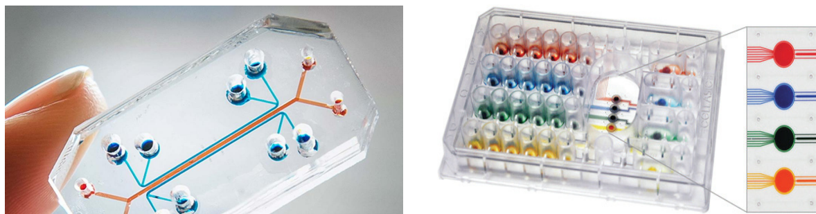
3. ábra A képen látható mikroszipekkel gyógyszerek hatását vizsgálják emberi szöveteken
