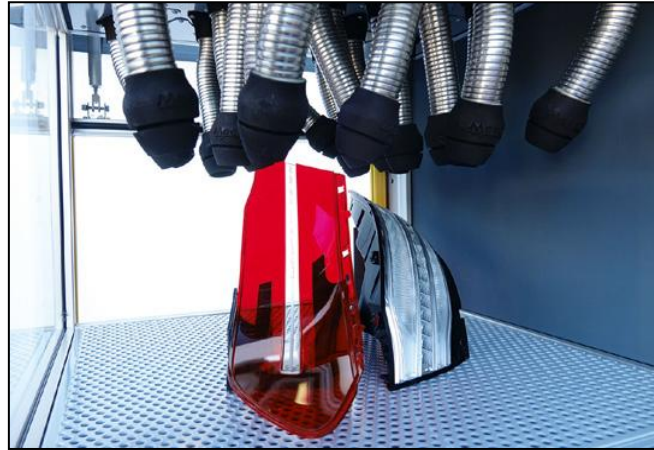
1. ábra Az automatizált fúvóka- és vákuumrendszer hatékonyan ionizálja a levegőt és szívja el a felületről felszabaduló szennyeződések
