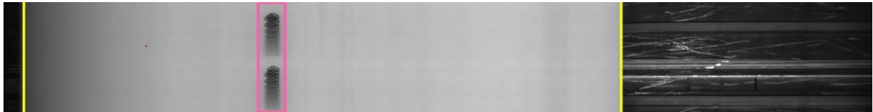
2. ábra A Strelen cég Safe-Ident Impurity eljárásával kimutatott szennyeződés (a rózsaszínnel keretezett területen)
