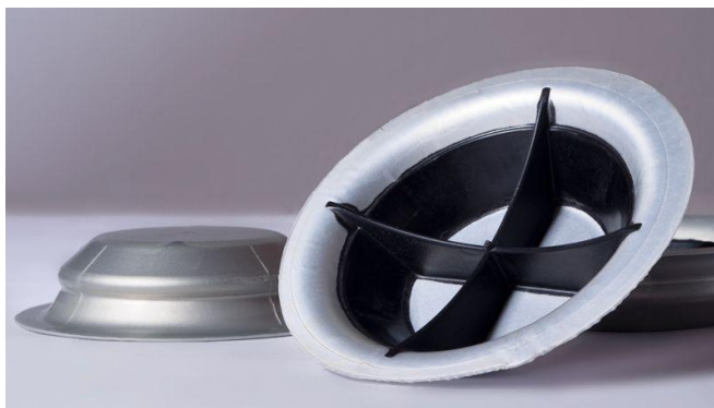
1. ábra A TU Chemnitz mélyhúzással gyártott hibrid formadarabja
