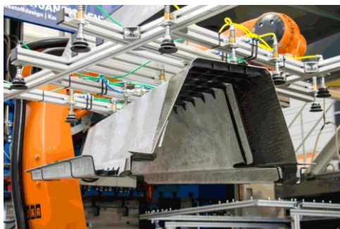
5. ábra A Leika projekt kutatóinak acélból, magnéziumból és szénszállal erősített műanyagból hibrid technológiával kialakított akkumulátoralagútja
