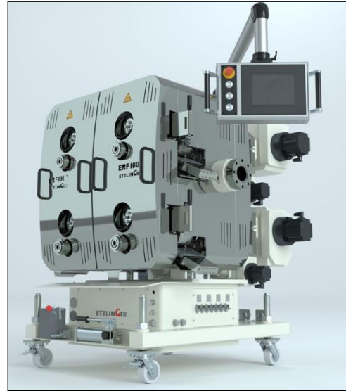
2. ábra Az Ettlínger cég ERF 1000 jelzésű négyyszeres szűrőmodulja
