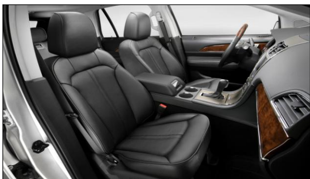
3. ábra. A Ford Lincoln MKX központi konzuljára helyezett, cellulózszálal PP-ből fröccsöntött karfa
