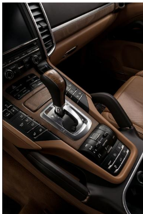
1. ábra A Kraton fröccsöntött IMSS burkolatával fedett középkonzol
