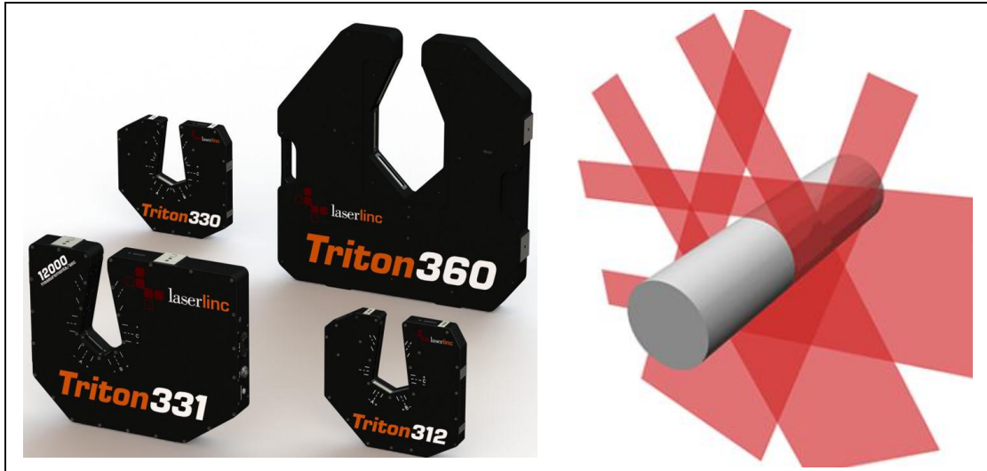
2. ábra A LaserLinc néhány pásztázó lézeres mikrométere (balra) és a háromtengelyű változatok (ilyen a Triton 360 ) egymással 60^\circ -ot bezáró mérősugarai (jobbra)
