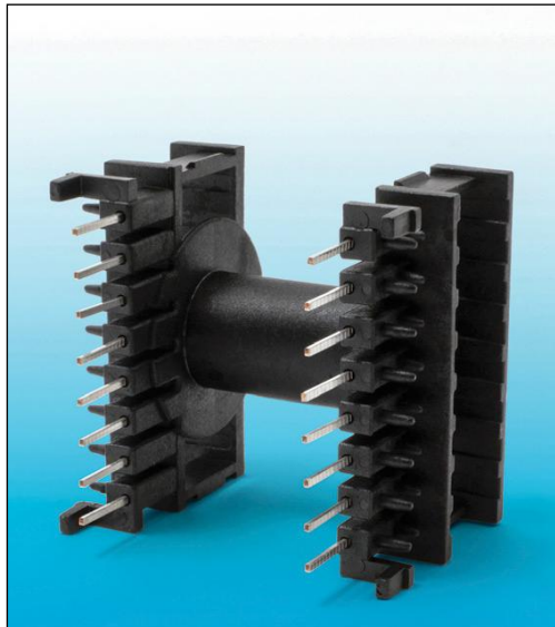
4. ábra Ferritmagos transzformátorhoz gyártott csévetest a Lati Larton G/40 márkájú PPS-éből
