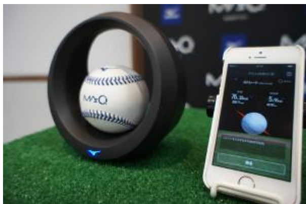
6. ábra A Mizuno „okos” labdáját éppen feltöltik a huzalmentes töltőben. A mellette látható okostelefonon leolvashatók a labdába épített érzékelőkkel mért adatok, a dobás sebessége vagy más jellemzők
