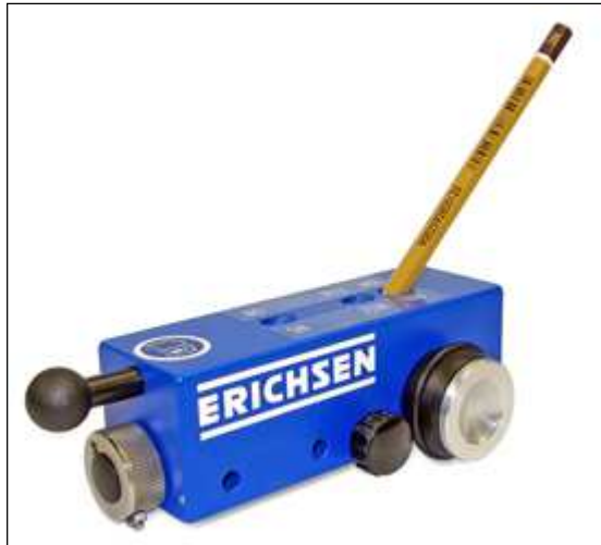
7. ábra Az Erichsen cég ceruzakeménységet mérő eszköze
