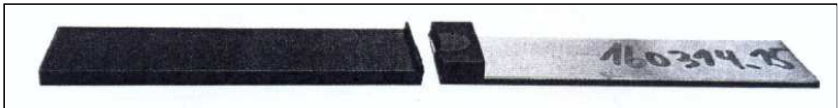
2. ábra A nyírószilárdság meghatározásához használt húzóvizsgálatokhoz alkalmazott (elszakított) próbatest
