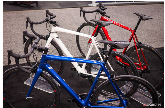
4. ábra Innegra PP-szállból és szénszállból gyártott vázakkal és kormányokkal készített kerékpárok
