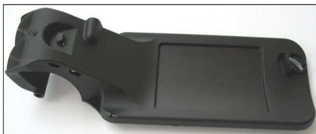
2. ábra Az Audi egyik üzemanyagtartályának lezárásához Fibremod CT -ből készített zsarnírkar. Ezzel egy 50% üvegszálát tartalmazó PA6-ot váltottak fel és 30%-kal csökkentették a zsarnírkar tömegét
