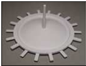
3. ábra Központi beömléses kísérleti fröccsszerszám, amelynél az egyes „nyelvek” eltérő falvastagsággal és eltérő méretű szellőzőréssel lettek kialakítva
