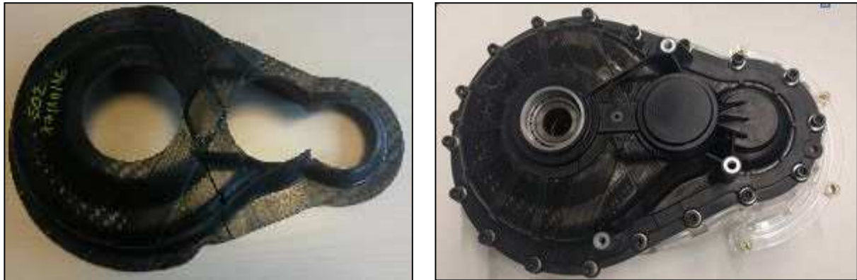
1. ábra A kompozitlemezből és az erősítő UD szalagokból meleg sajtolással kialakított és vízszaggal méretre vágott előgyártmány (bal oldalt) és az előgyártmányra ráfröccsöntött rövid üvegszálakkal erősített poliamiddal kialakított sebességváltó ház prototípus egyik fele (jobb oldalt)
