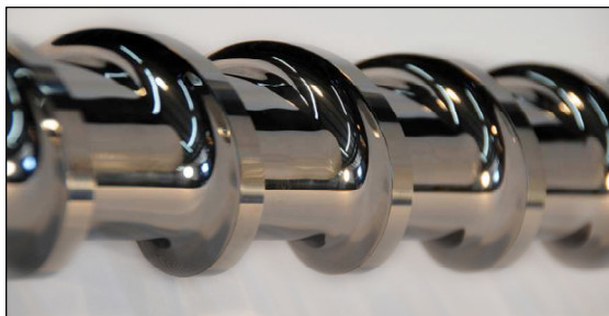
6. ábra Nitridált extrudercsiga etetőzónája 10 hónapos PVC-extrudálás után (A kép); CarbideX-CRP bevonattal ellátott csiga 10 hónap után ugyanebben a folyamatban (B kép)
