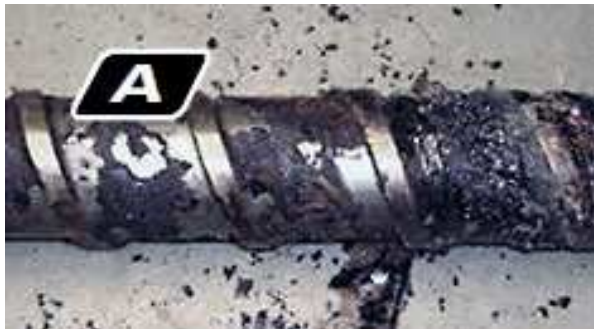
6. ábra Nitridált extrudercsiga etetőzónája 10 hónapos PVC-extrudálás után (A kép); CarbideX-CRP bevonattal ellátott csiga 10 hónap után ugyanebben a folyamatban (B kép)
