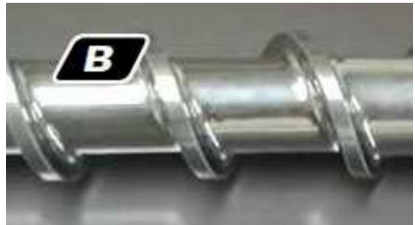
6. ábra Nitridált extrudercsiga etetőzónája 10 hónapos PVC-extrudálás után (A kép); CarbideX-CRP bevonattal ellátott csiga 10 hónap után ugyanebben a folyamatban (B kép)
