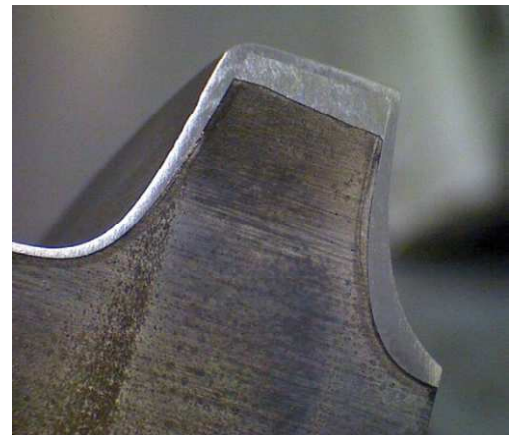
5. ábra Egy csiga felületkezelése a Nordson cég Xaloy MPX technológiájával (balra) és egy Xaloy réeggel bevont csigaszárny metszete
