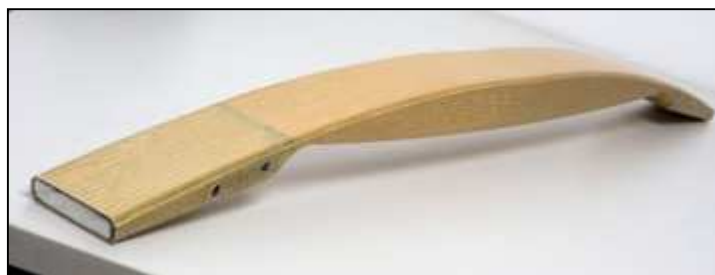
1. ábra Egy Rohacell habmagú, PulPres eljárással készült kompozittermék 75%-kal könnyebb, mint a hagyományos acél alkatrész
