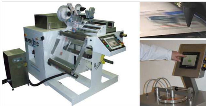
2. ábra A Perfo Tec cég EMAP fóliaperforálója (balra), az inline lézeres fóliaperforálás (jobbra fenn) és a termény lélegzésének mérése (jobbra lenn)
