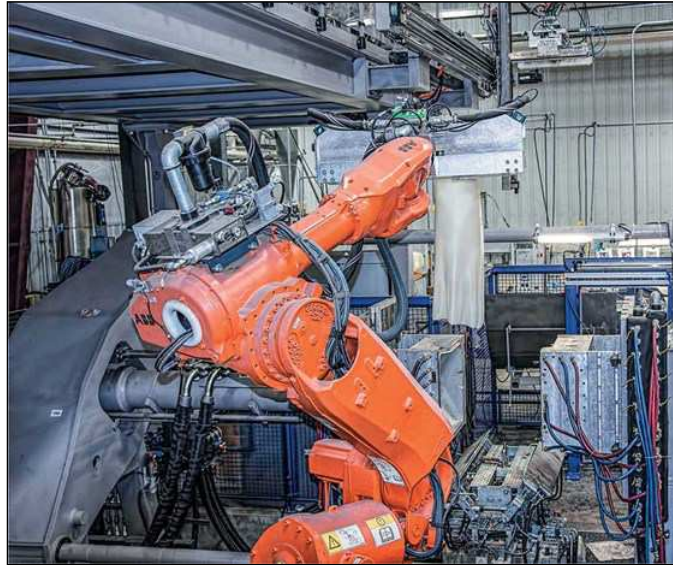
2. ábra. 6-tengelyű robot szállítja az előformákat
