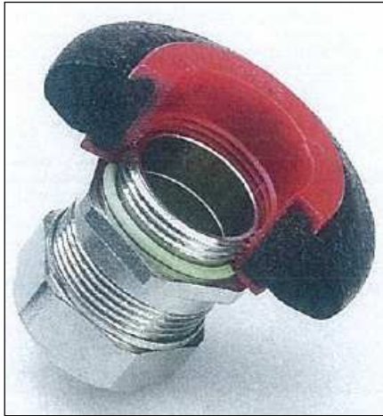
3. ábra Menetes hüvelyt tartalmazó K-Fix elem. A hüvely tömör hőre lágyuló műanyagba van ágyazva, ezt veszi körül a tömítést szolgáló részecskehab
