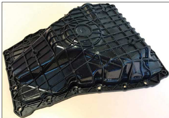
1. ábra A DuPont cég Vizilon TPC anyagából a Nifco cég tervei alapján legyártott olajtálca prototípusa
