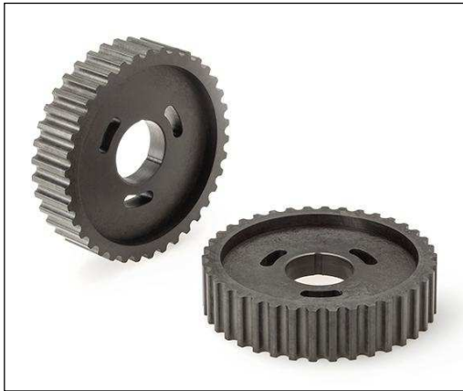
3. ábra A Solvay cégnél PAI-ból készített bütyköstengely-kerekek szerállósága, inkább méretállandósága miatt választották ki.
