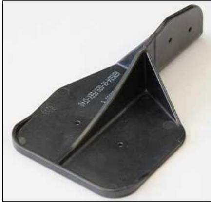
4. ábra Az Airbus A350 XWB repülőgép ajtajának PEEK-ből készített tartóeleme
