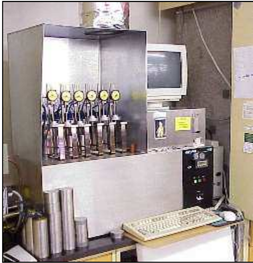
3. ábra HDT és Vicat hőmérséklet meghatározására alkalmas készülék (ASTM D 648, ISO 75)
